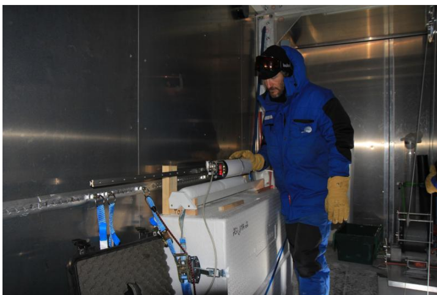
FIGURE 6 – Mesure de la SSA par Ghislain Picard avec ASSSAP sur un tronçon de carotte de la traverse ASUMA, photo Bruno Jourdain
