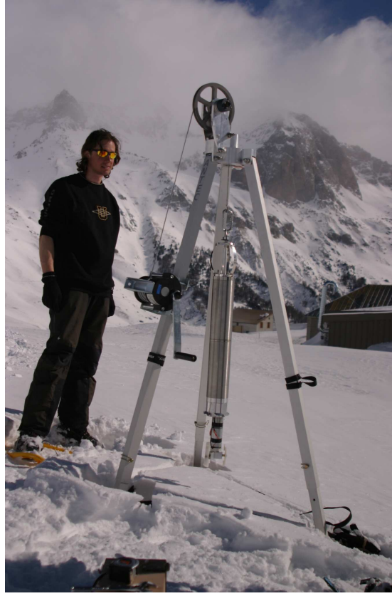
FIG. 3 – Photo du trépied et de la sonde le 11 mars 2009 au col du Lautaret
