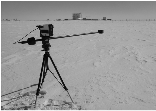
FIGURE D.1 – (gauche) Spectrophotomètre SVC® HR1024 lors d'une mesure d'albédo spectral à proximité de la station Concordia. La sphère intégrante se trouve à l'extrémité du bras horizontal. (droite) Variations du ratio \ln(\alpha_\lambda(\mu)) / \ln(\alpha_\lambda(\mu^*)) à 1300 nm en fonction de \mu : comparaison entre mesures et théorie avec \mu^* = 0.46 . La courbe théorique correspond à la fonction \frac{1 + 2\mu}{1 + 2\mu^*} .
