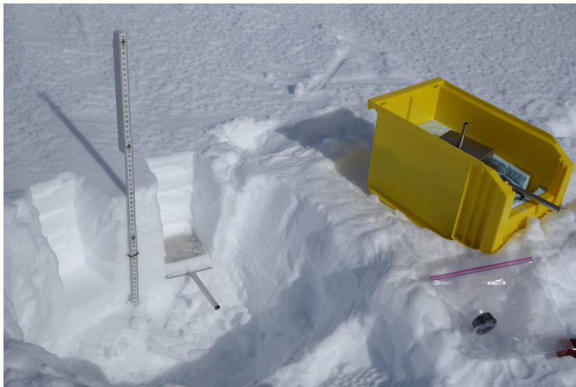
FIGURE 2.1 – Mesure de masse volumique effectuée à Dôme C durant la campagne de mesures 2012 – 2013, avec une pelle parallélépipédique de 250 \text{ cm}^3 , et à une résolution verticale de 2.5 \text{ cm} .
